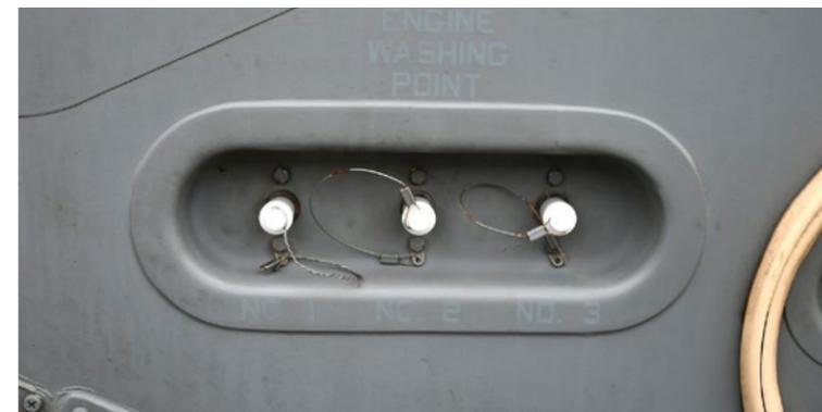
Le valvole per il lavaggio con acqua distillata dei tre motori dell'EH-101
