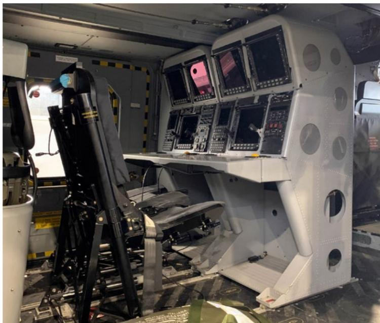
Console Radar e Sonar a bordo di un SH-90A
