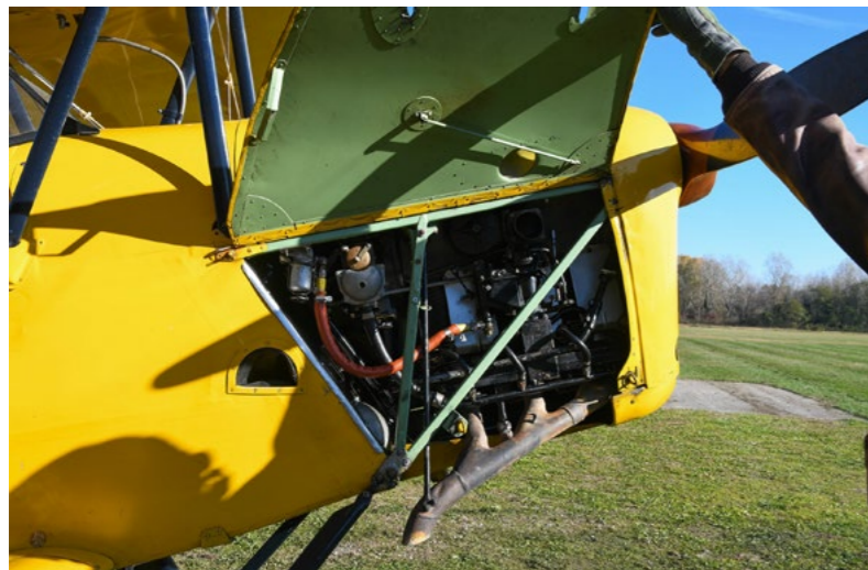
Il motore Gipsy Major IIIA, un quattro cilindri in linea invertito da 6 litri di cilindrata
