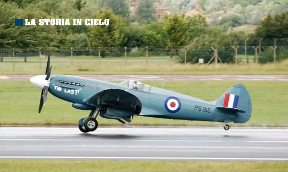
In atterraggio lo Spitfire Mk XIX con il motore Griffon 58, riconoscibile dai rigonfiamenti sul cofano
