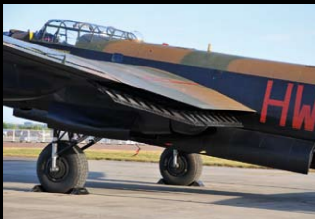
Nel particolare gli split flap del Lancaster che negli anni '50 fu destinato a esperimenti di volo senza piloti a bordo, poi mai effettuati; uscì dalla linea di volo nel 1963
