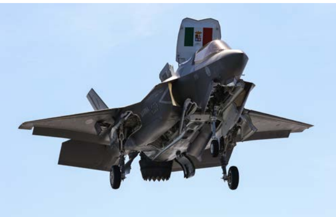
Un F-35B in atterraggio verticale, l'ugello posteriore è rivolto a 90° in basso
