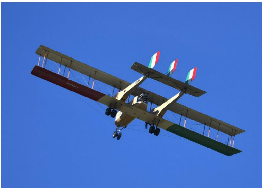
**In volo** la grossa ala rettangolare di grande apertura e la particolare fusoliera bitrave con cabina anteriore prolungata sono all'origine di una caratteristica instabilità direzionale
