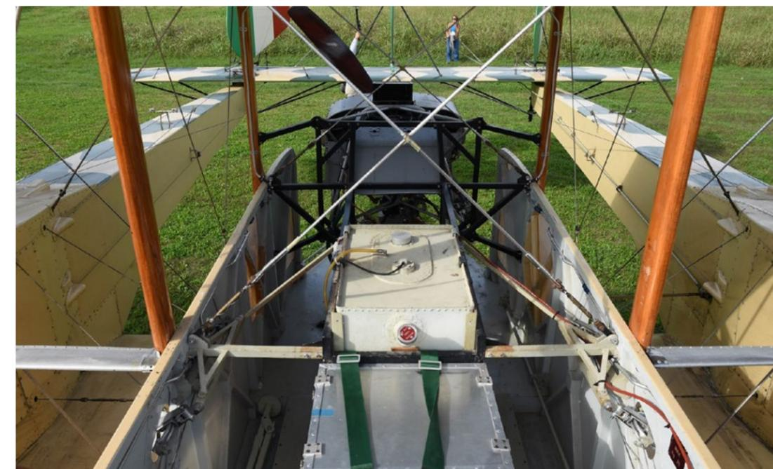
Ogni motore (in foto il posteriore) dispone di un proprio serbatoio, cui si aggiungono due serbatoi alari per un totale di 700 litri
