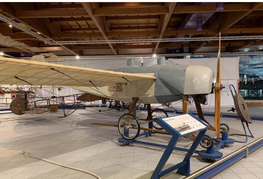
scuole di volo. Ha una fusoliera in legno rivestita in compensato e tela, adattabile a usi e motorizzazioni diverse. L'apparecchio esposto è stato costruito inizialmente con carrello fisso e successivamente trasformato in idrovolante. Nel 1964 è stato radiato in seguito ad un incidente e donato al Museo Caproni nel 1970.
