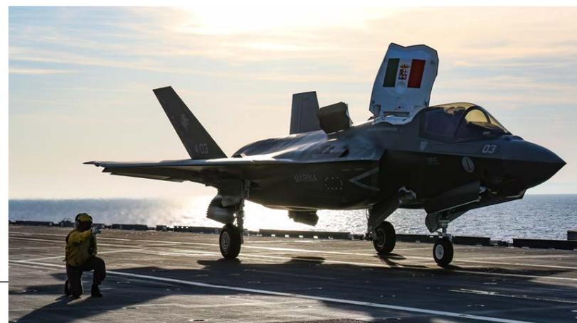
Caratteristica unica dell'F-35B è quella di poter operare senza necessità di catapulte e cavi di arresto
