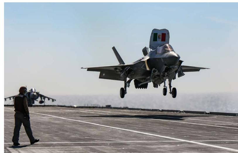
**Il controllo del rotolo** durante l'atterraggio verticale è ottenuto con getti d'aria spillati dal compressore a bassa pressione
